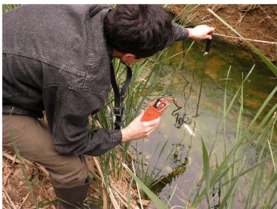
Μέτρηση ταχύτητας ροής νερού με τη χρήση μολίσκου σε ρέμα της Ανατολικής Αττικής.
