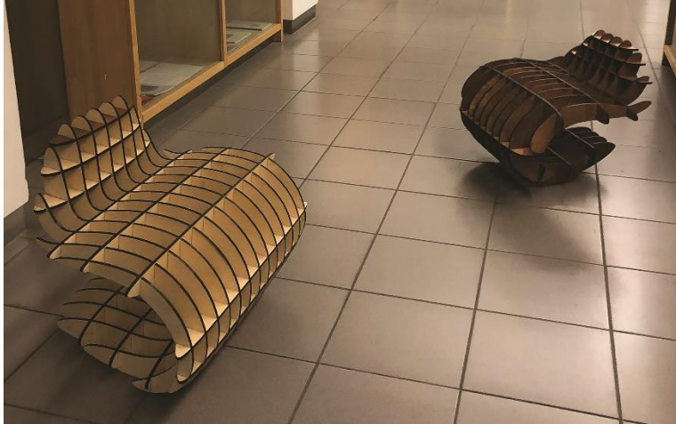
Παραμετρικός σχεδιασμός κουνιστής καρέκλας με waffle structure και υλοποίηση με laser cutting
