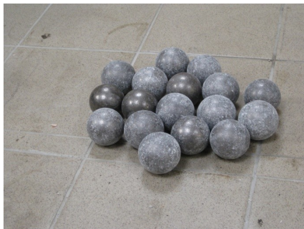
Εικ. 2: Χαλύβδινες σφαίρες, που τοποθετούνται στη συσκευή.
